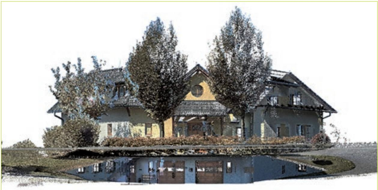
Darstellung eines Hauses auf Basis von Laser Scan Daten, photogrammetrischen Daten und tachymetrischen Messpunkten.
